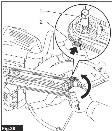
4. Empuje hacia dentro el botón de bloqueo del eje y sujételo para bloquear la polea grande, y después gire el disco pequeño hacia la izquierda utilizando el extremo grueso de la llave de tubo para aflojar la correa sincrónica.
