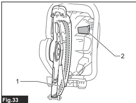
► 1. Cubierta del disco 2. Lente de la lámpara
