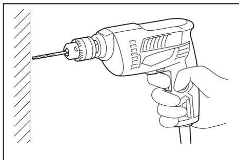
Sujete siempre la herramienta solamente por la empuñadura cuando realice una operación. No toque la parte metálica.
