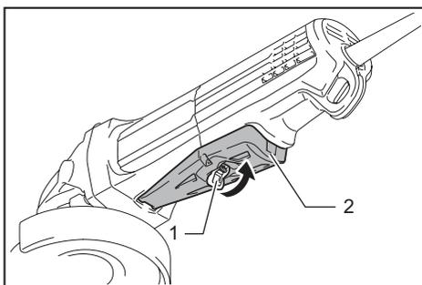
► 1. Palanca de desbloqueo 2. Interruptor de palanca
