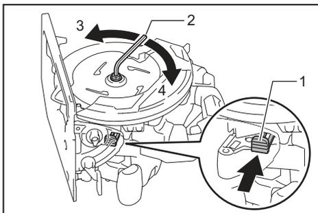
► 1. Bloqueo del eje 2. Llave hexagonal 3. Aflojar 4. Apretar
