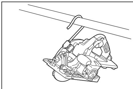
Coloque el gancho con los tornillos como se muestra en la ilustración.
