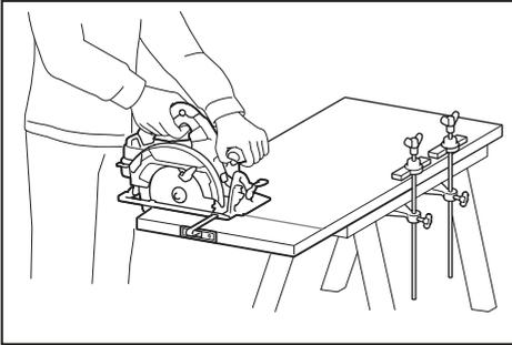
5. **Cuando realice una operación en la que el implemento de corte pueda entrar en contacto con cableado oculto, sujete la herramienta eléctrica por las superficies de aislamiento aisladas solamente.** El contacto con un cable con corriente también hará que la corriente circule por las partes metálicas expuestas de la herramienta eléctrica y podrá soltar una descarga eléctrica al operario.
