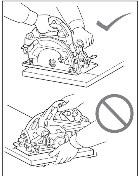
5. **Antes de dejar la herramienta después de completar un corte, asegúrese de que el protector se ha cerrado y que el disco se ha parado completamente.**
